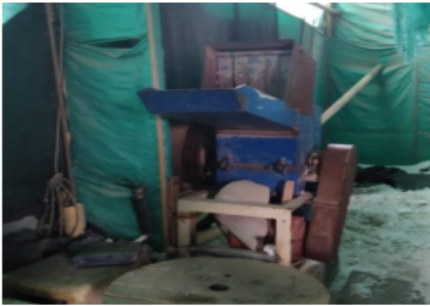
Fotografía 3: Molino para reciclaje de poliestireno
